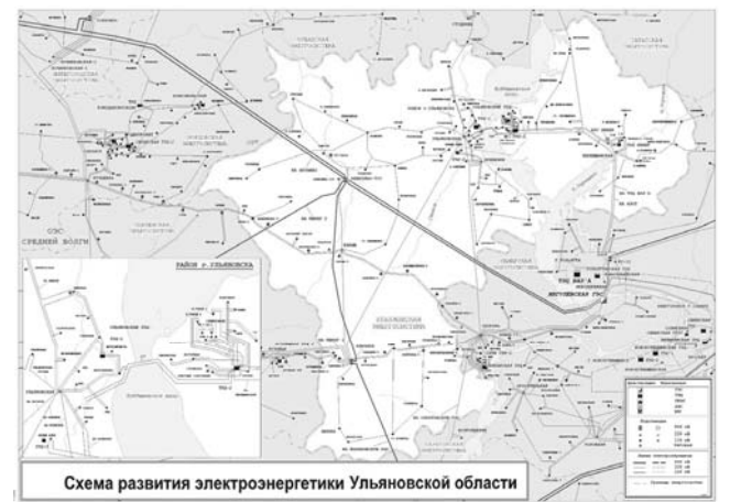
Рис. 2. Карта-схема электрических сетей 110 кВ и выше энергосистемы Ульяновской области на период 2018-2022 годов
